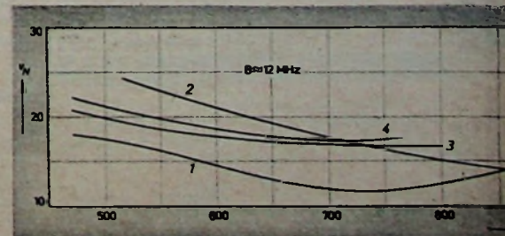
Bild 5. Leistungsverstärkung einer UHF-Vorstufe; 1 — mit Topfkreis üblicher Bemessung (wie bei der PC 86), 2 — ohne Knotentrimmer, 3 — Topfkreis 10 mm verlängert (mit Knotentrimmer), 4 — wie 3, jedoch Topfkreis 15 mm verlängert
